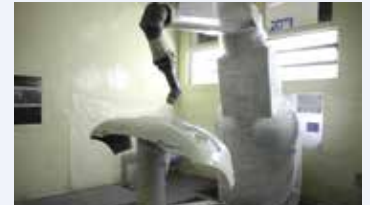
機械で塗料を吹き付ける
