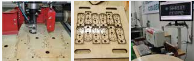
철판,아크릴, 합판, 빼그라이트등 레이저커팅
