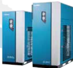
AD-HT 시리즈 (일체형 드라이버) 에프터 쿨러, 에어필터, 에어 드라이어 일체형으로 설치면적 최소화. 입구온도 80°C 설계로 더운 동남아 지역에 최적함.
